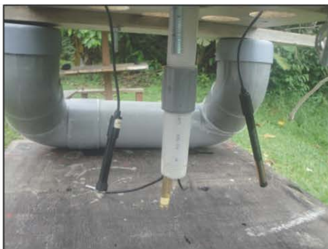
Imagen 35: La nueva estructura mecánica con los sensores instalados por la parte de abajo para que tengan contacto con el agua.
