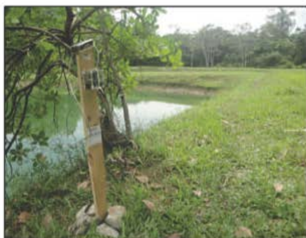
Imagen 31: Estructura mecánica de un NODO coordinador (repetidor) usado en las pruebas iniciales.
