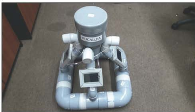
Imagen 39: Estructura mecánica definitiva que contiene la electrónica del nodo sensor.
