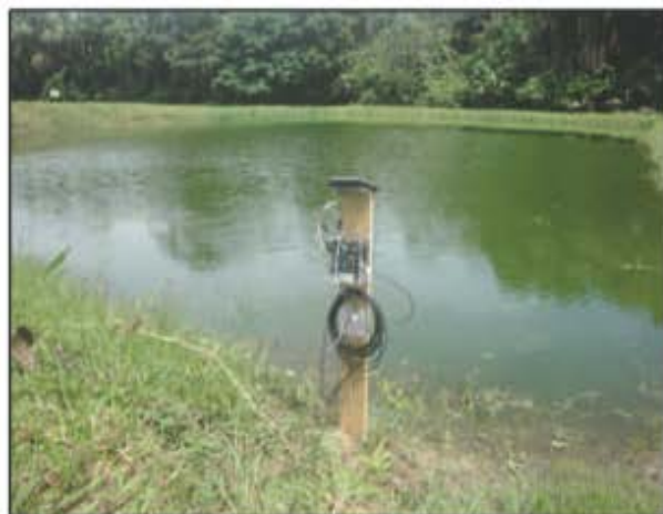
Imagen 32: Estructura mecánica del NODO sensor usado en las pruebas iniciales. Obsérvese las celdas solares arriba y los cables de sensores en el agua abajo).
