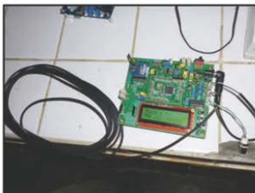
Imagen 30: Electrónica del NODO sensor usado en las pruebas Iniciales. (Observese el módulo Xbee, que es el módulo de radio del NODO).
