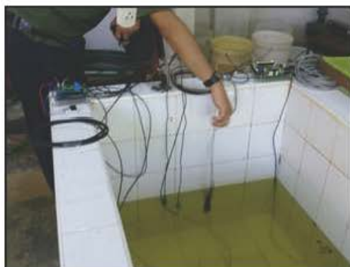
Imagen 29: Pruebas Iniciales de captura de datos de temperatura y pH medidos con sensores bajo techo.
