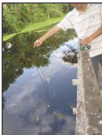
Imagen 28: Pruebas Iniciales de captura de datos de temperatura y pH medidos con sensores en estanque artificial (campo abierto).
