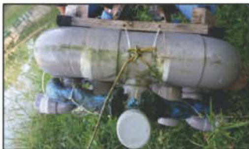
Imagen 38: La madera y la espuma se deterioraron hacia el cuarto mes de funcionamiento.
