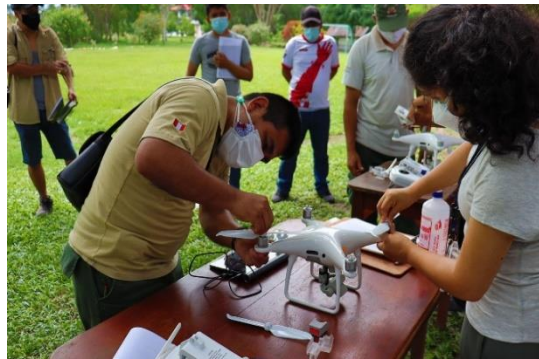
Figura 17: Demostración de ensamblaje de las hélices en el RPA.
