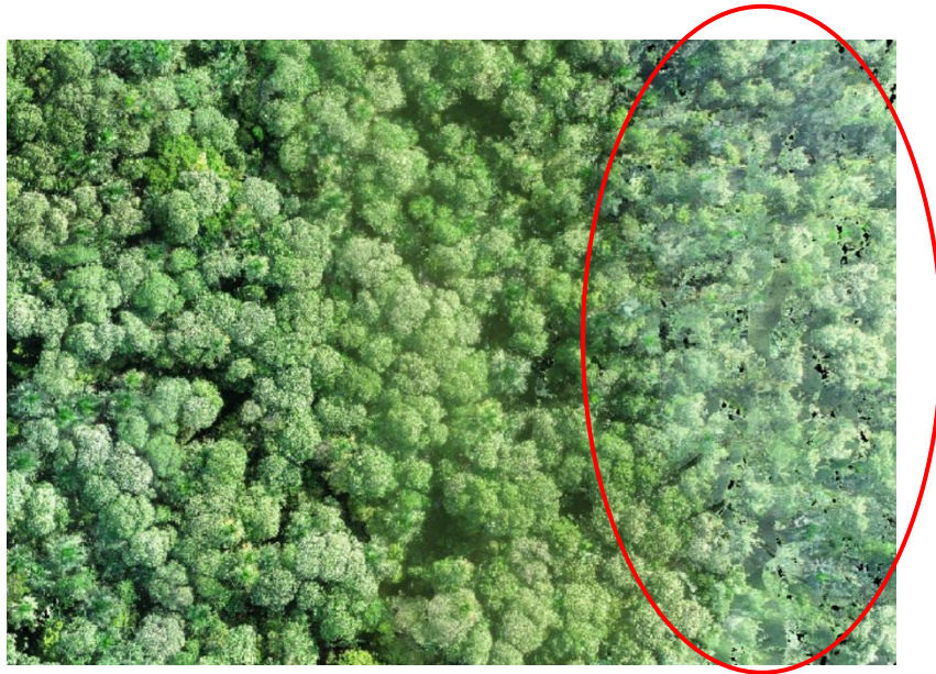
Figura 9: Parte de un mosaico obtenido usando el software Pix4D mapper. La parte señalada en rojo presenta “agujeros” negros y zonas borrosas debido a la falta de imágenes con suficiente traslape para poder reconstruir el mosaico.
